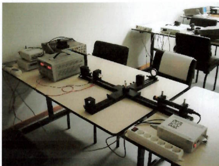
Figura 22 – Interferômetro de Michelson montado para a experiência
