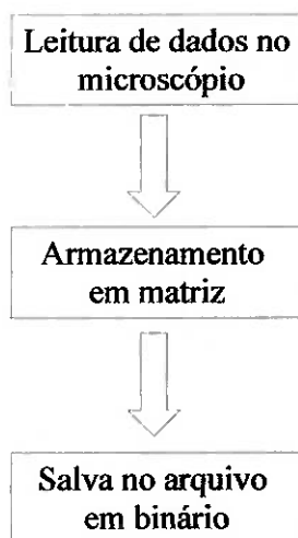
Figura 16 - Diagrama em blocos do carregamento da imagem
